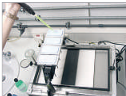
Abb. 3 Auftragen der Testreiniger.
