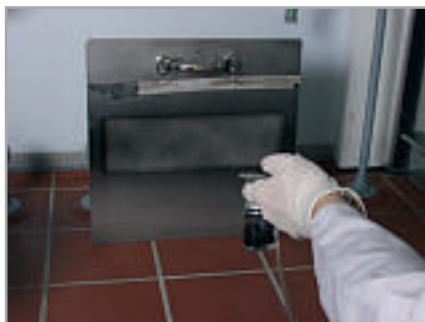
Abb. 1 Auftragen der Testschmutzes mit einer Schablone.
